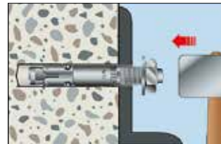
3. Bolzenanker durch zu befestigendes Bauteil stecken und einschlagen
