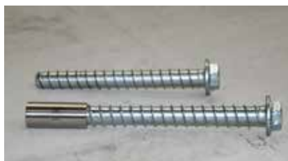
Schraube zur Weiterverwendung geeignet
